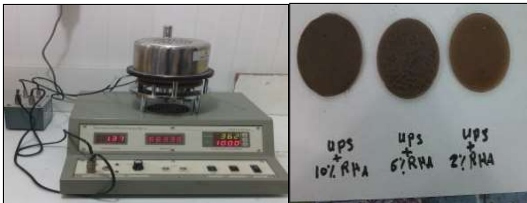
شكل رقم (3) : جهاز اختبار معامل التوصيل الحراري وشكل عينات الاختبار
